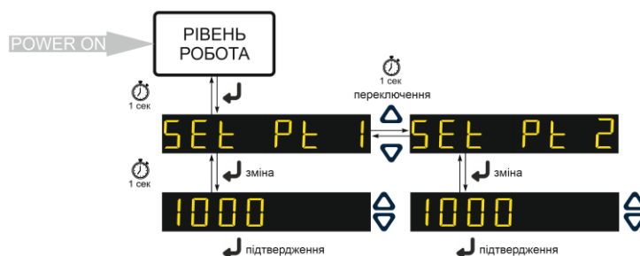
Рисунок 3.4 – Діаграма відображення зміни величини уставок "SET POINT 1" та "SET POINT 2"
