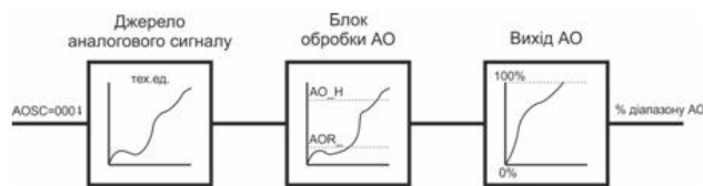
Рисунок 2.3 - Робота блоку аналогового виведення в режимі перетворення
