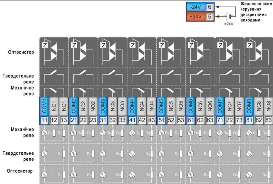
Рисунок Б.3.1 – Підключення дискретних виходів за допомогою клемно-блочного з'єднувача KB3-30P(C,K)-11
