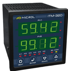
Рисунок А.1 – Зовнішній вигляд індикатора ITM-320 та розміри цифрових індикаторів(тип індикаторів - 0)
