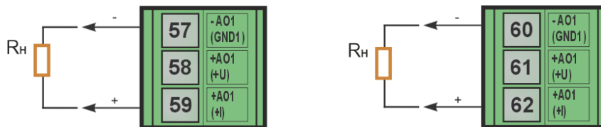
Рисунок Б.3.3– Схема підключення виходу постійної напруги
