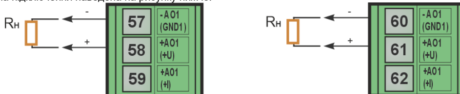
Рисунок Б.3.6 – Схема підключення виходу постійної напруги
