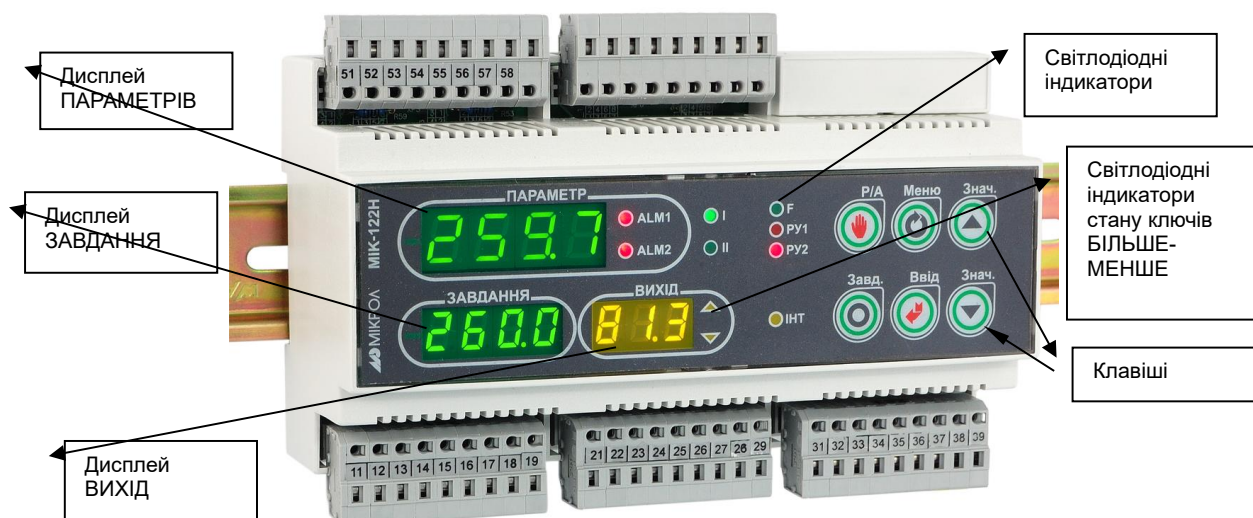
Рисунок 3.1 - Зовнішній вигляд передньої панелі регулятора МІК-122Н
