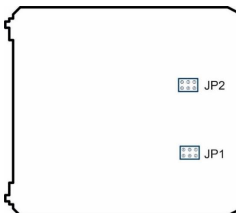
Рисунок 2.10 положення перемичок на платі
