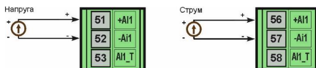
Рисунок Б.2.5 - Схема підключення уніфікованих сигналів активного типу
