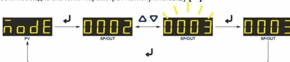
Рисунок 2.7 – Фіксація зміни параметру регулятора MIK-322-K7
