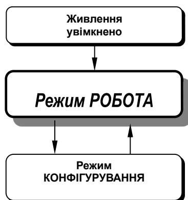
Малюнок 4.1 - Діаграма режимів роботи та налаштування індикатора ITM-22 (ITM-20)
