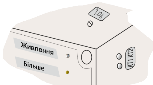
Рисунок 4.3 – Схема встановлення струмового захисту у пускачі
