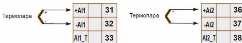
Рисунок Б.2.3 – Схема підключення термопар
