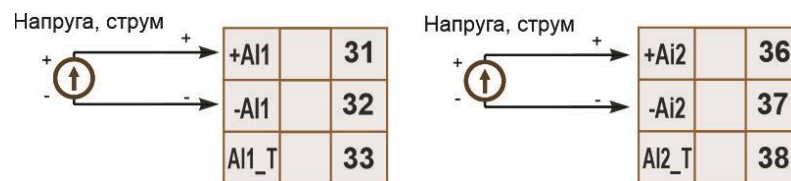
Рисунок Б.2.5 - Схема підключення уніфікованих сигналів активного типу
