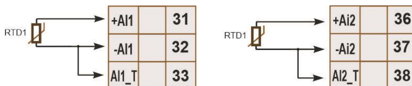
Рисунок Б.2.2 – Двох провідна схема підключення термоопорів
