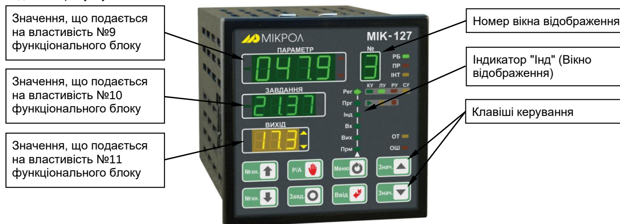
Рисунок 4.6 - Передня панель в режимі оперативного керування користувацькими панелями
