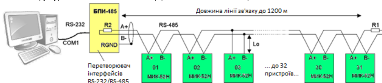
Рисунок 3.1 - Структурна схема підключення інтерфейсних кіл
