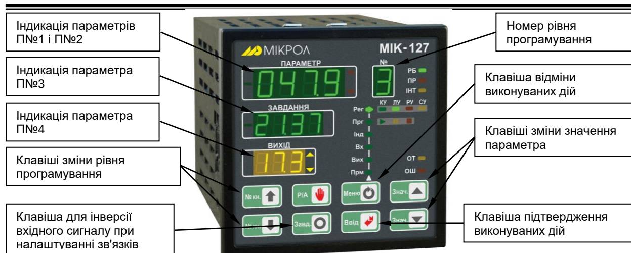
Рисунок 5.1 - Передня панель регулятора MIK-127 в режимі програмування
