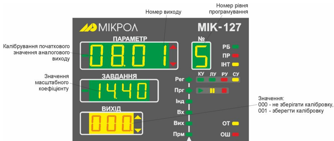
Рисунок 9.4.2.1 - Зовнішній вигляд індикаторів при калібруванні початкового значення аналогового виходу
