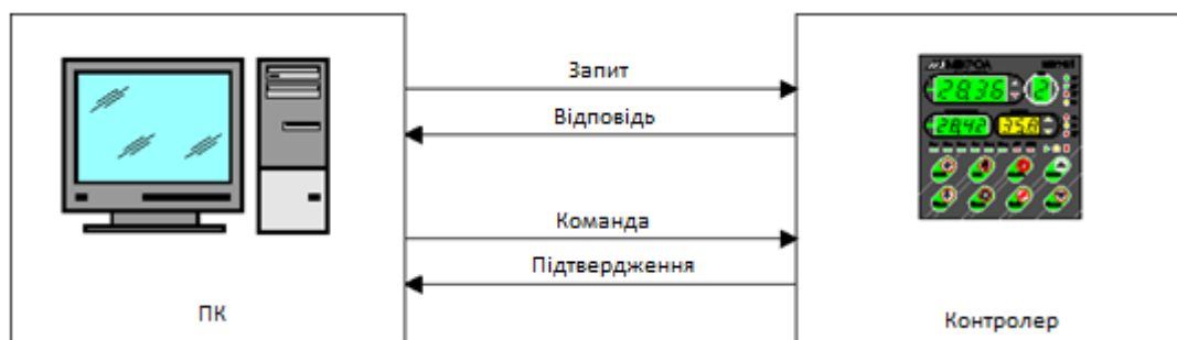
Рисунок 3.3 - Види повідомлень при зв'язку з комп'ютером
