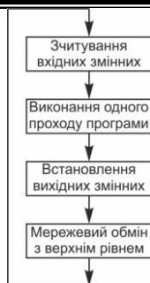
Рисунок 2.8 - Циклограма роботи регулятора
