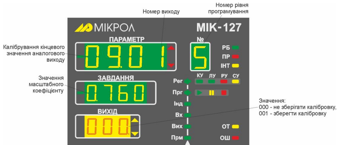
Рисунок 9.4.2.2 - Зовнішній вигляд індикаторів при калібруванні кінцевого значення аналогового виходу
