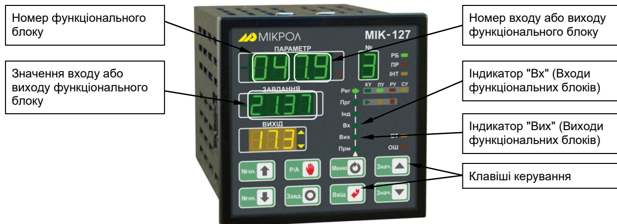
Рисунок 4.7 - Передня панель в режимі індикації вхідних або вихідних параметрів функціональних блоків
