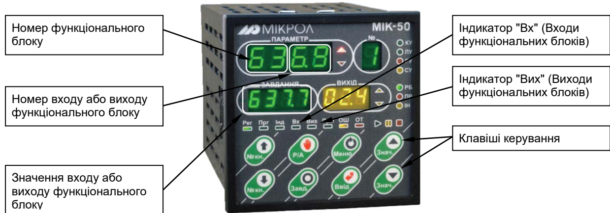
Рисунок 4.7 - Передня панель в режимі індикації вхідних параметрів функціональних блоків
