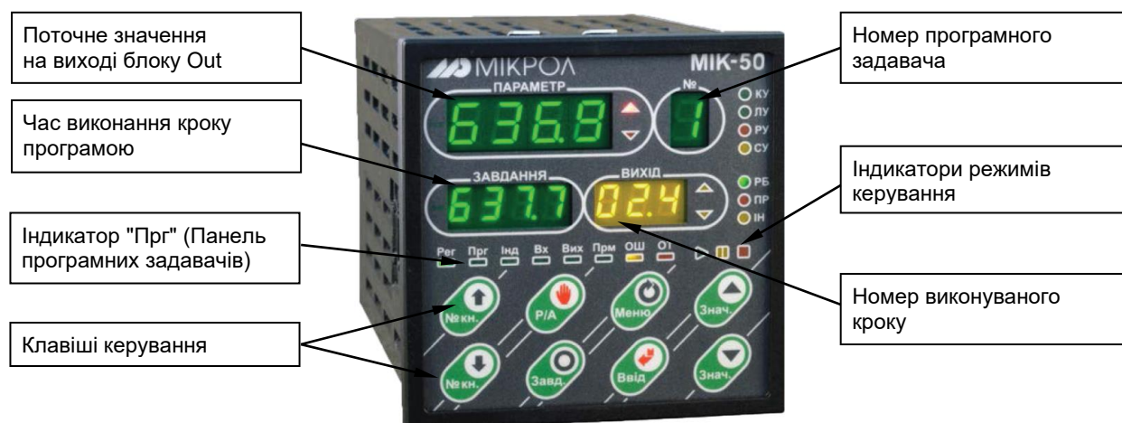
Рисунок 4.5 - Передня панель в режимі оперативного керування програмним задавачем
