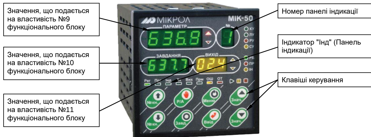
Рисунок 4.6 - Передня панель в режимі оперативного керування програмним задавачем
