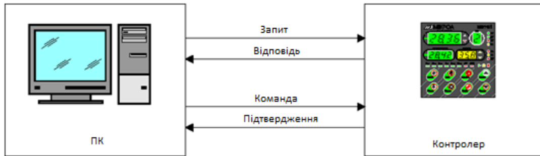
Рисунок 3.3 - Види повідомлень при зв'язку з комп'ютером
