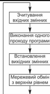
Рисунок 2.8 - Циклограма роботи контролера
