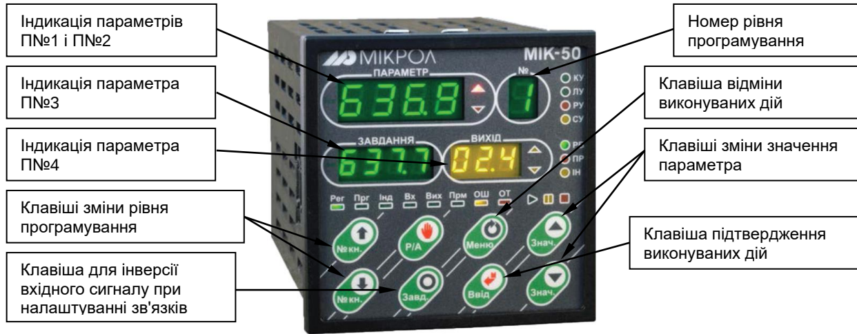
Рисунок 5.1 - Передня панель контролера МІК-50 в режимі програмування
