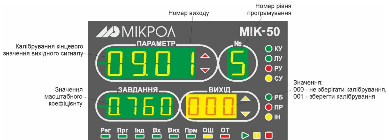
Рисунок 9.4.2.2 - Зовнішній вигляд індикаторів при калібрування кінцевого значення аналогового виходу
