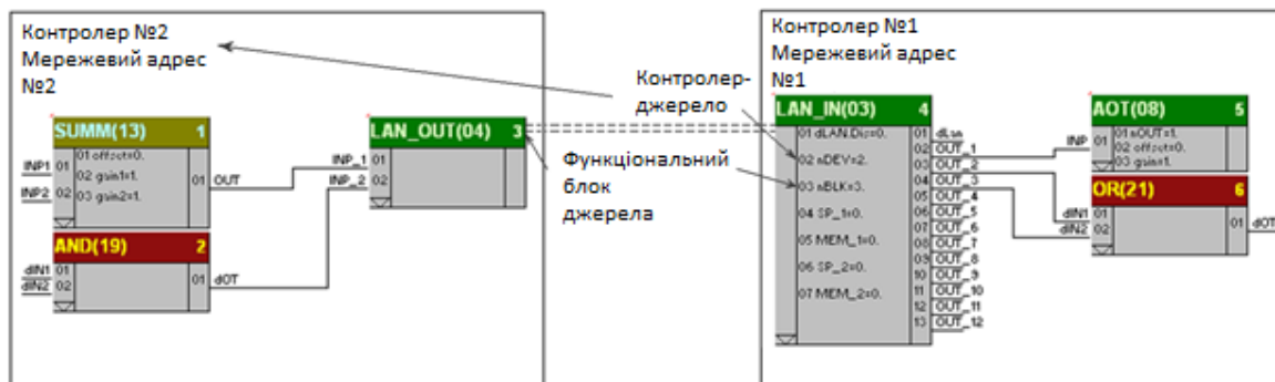
Рисунок 3.2 - Зв'язок двох контролерів через функціональні блоки інтерфейсного вводу-виводу
