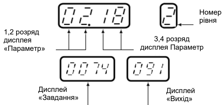
Рисунок 5.2 - Відображення параметрів налаштування в режимі програмування
