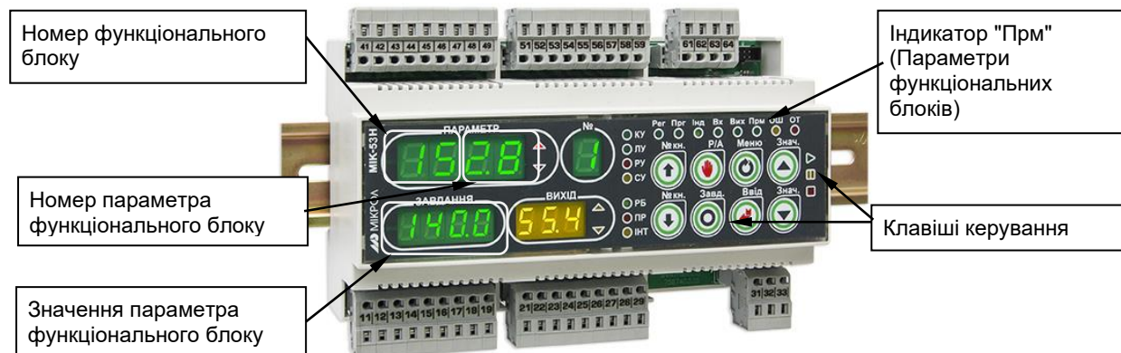
Рисунок 4.7 - Лицьова панель в режимі індикації параметрів функціональних блоків
