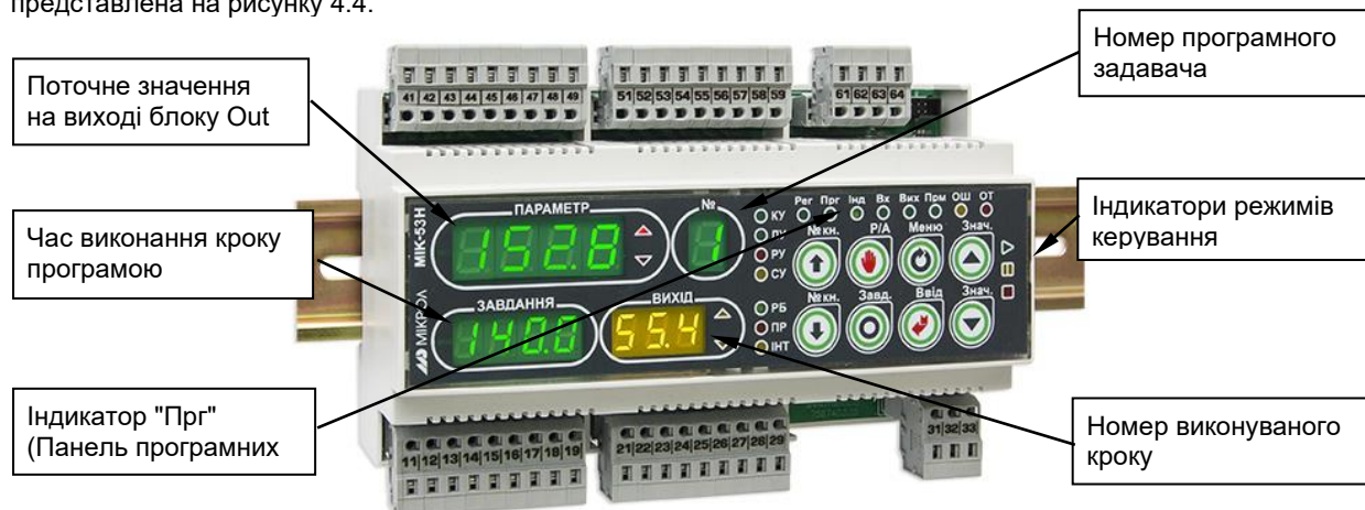
Рисунок 4.4 - Лицьова панель в режимі оперативного керування програмним задавачем
