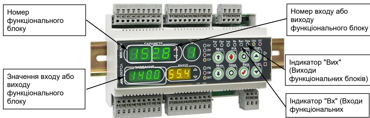
Рисунок 4.6 - Лицьова панель в режимі індикації вхідних або вихідних параметрів функціональних блоків
