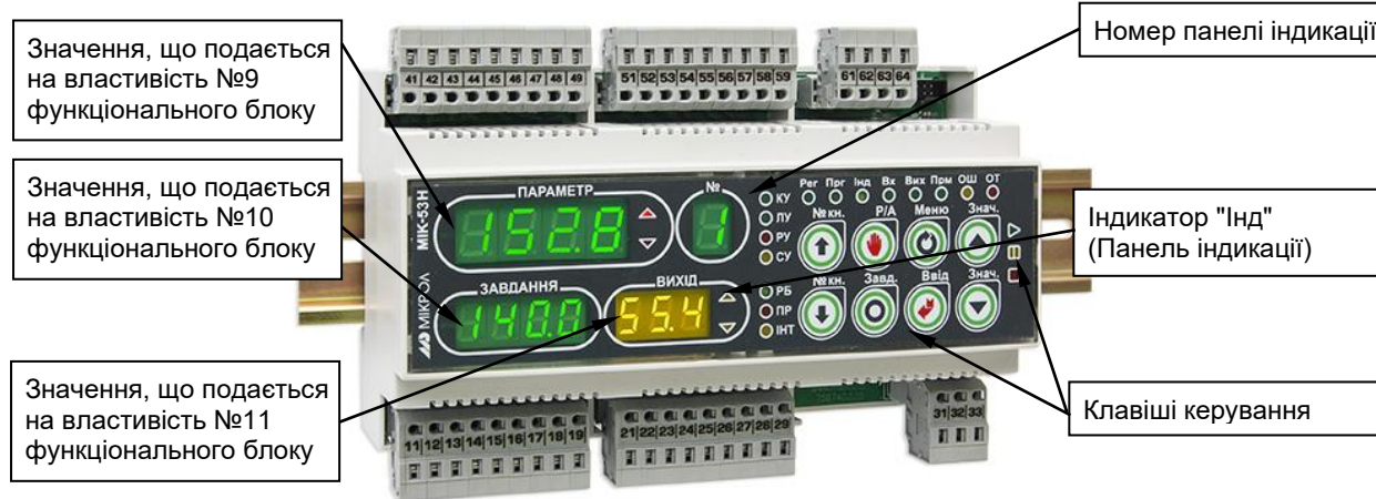
Рисунок 4.5 - Лицьова панель в режимі оперативного керування панелями, призначеними для користувача
