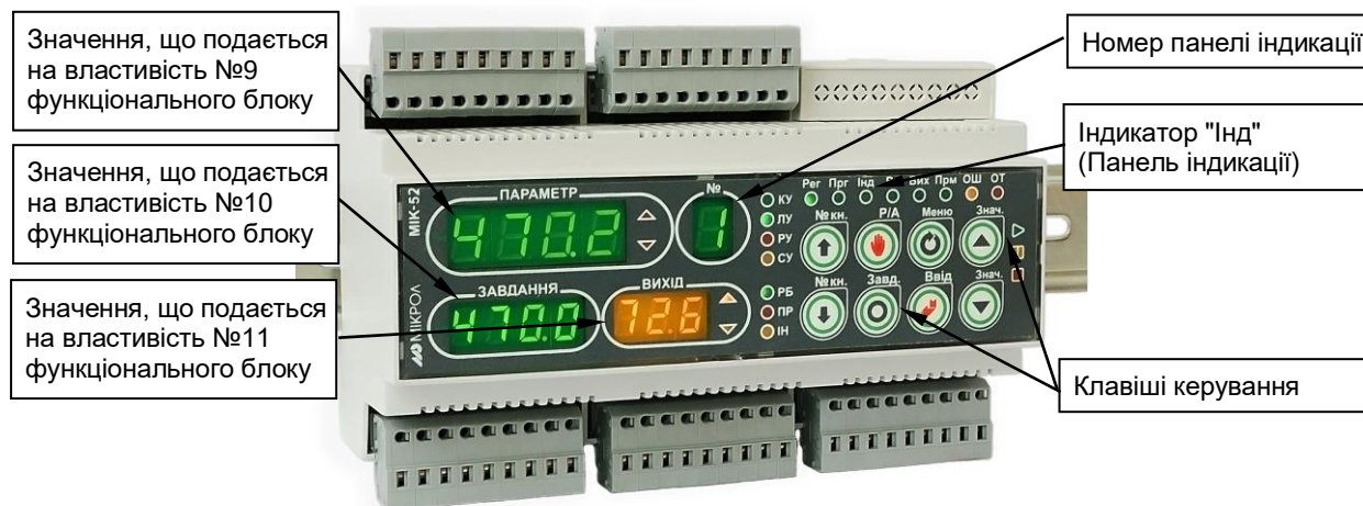
Рисунок 4.6 – Передня панель в режимі оперативного керування панелями індикації
