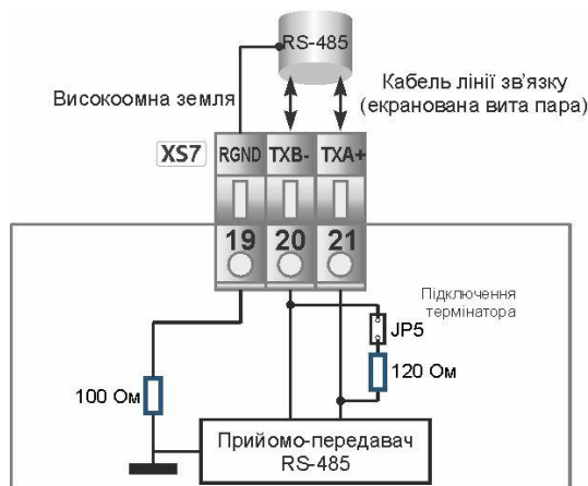
Рисунок 8.6 - Схема підключення інтерфейсу
