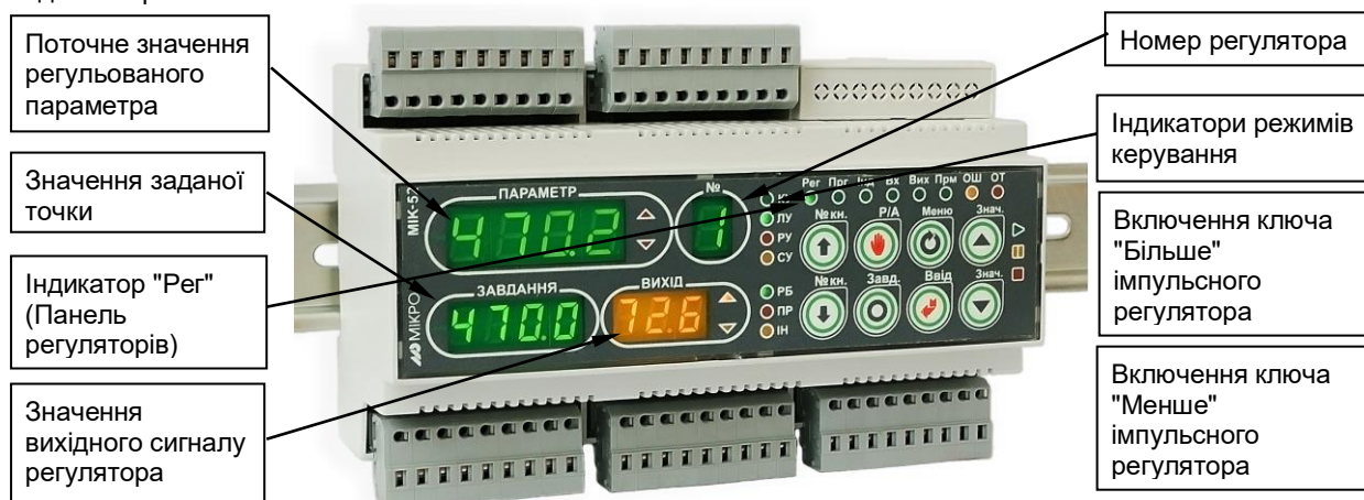
Рисунок 4.3 - Передня панель в режимі оперативного керування контурами регулювання
