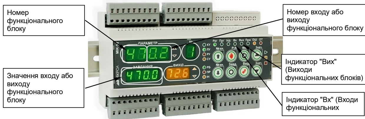
Рисунок 4.7 – Передня панель в режимі індикації вхідних або вихідних параметрів функціональних блоків
