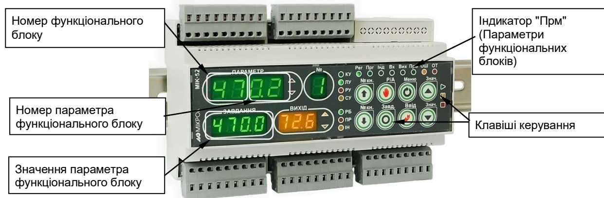
Рисунок 4.8 – Передня панель в режимі індикації параметрів функціональних блоків
