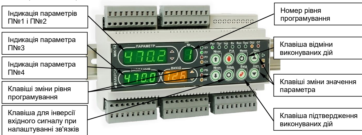
Рисунок 5.1 - Передня панель контролера МІК-52Н в режимі програмування
