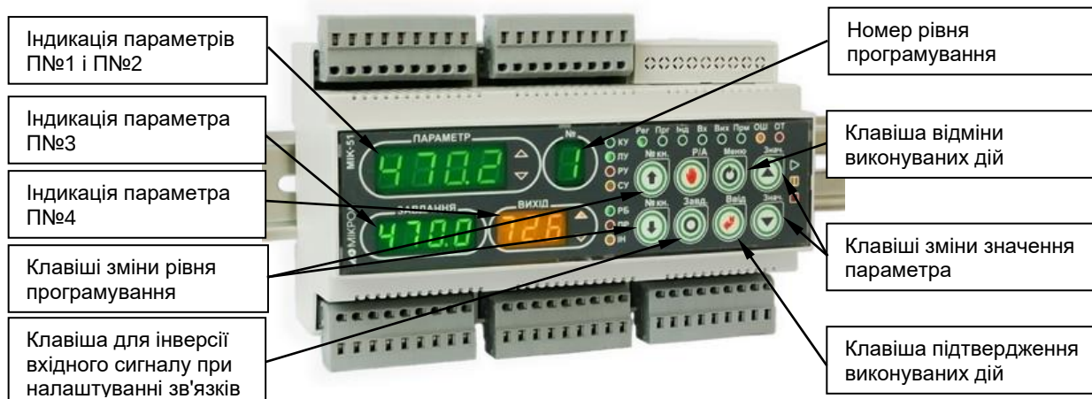
Рисунок 5.1 - Лицьова панель контролера МІК-51Н в режимі програмування
