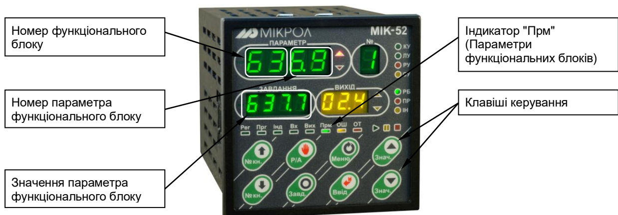
Рисунок 4.8 - Передня панель в режимі індикації параметрів функціональних блоків
