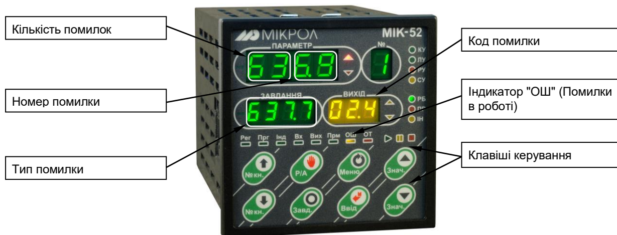
Рисунок 4.9 - Передня панель в режимі індикації помилок
