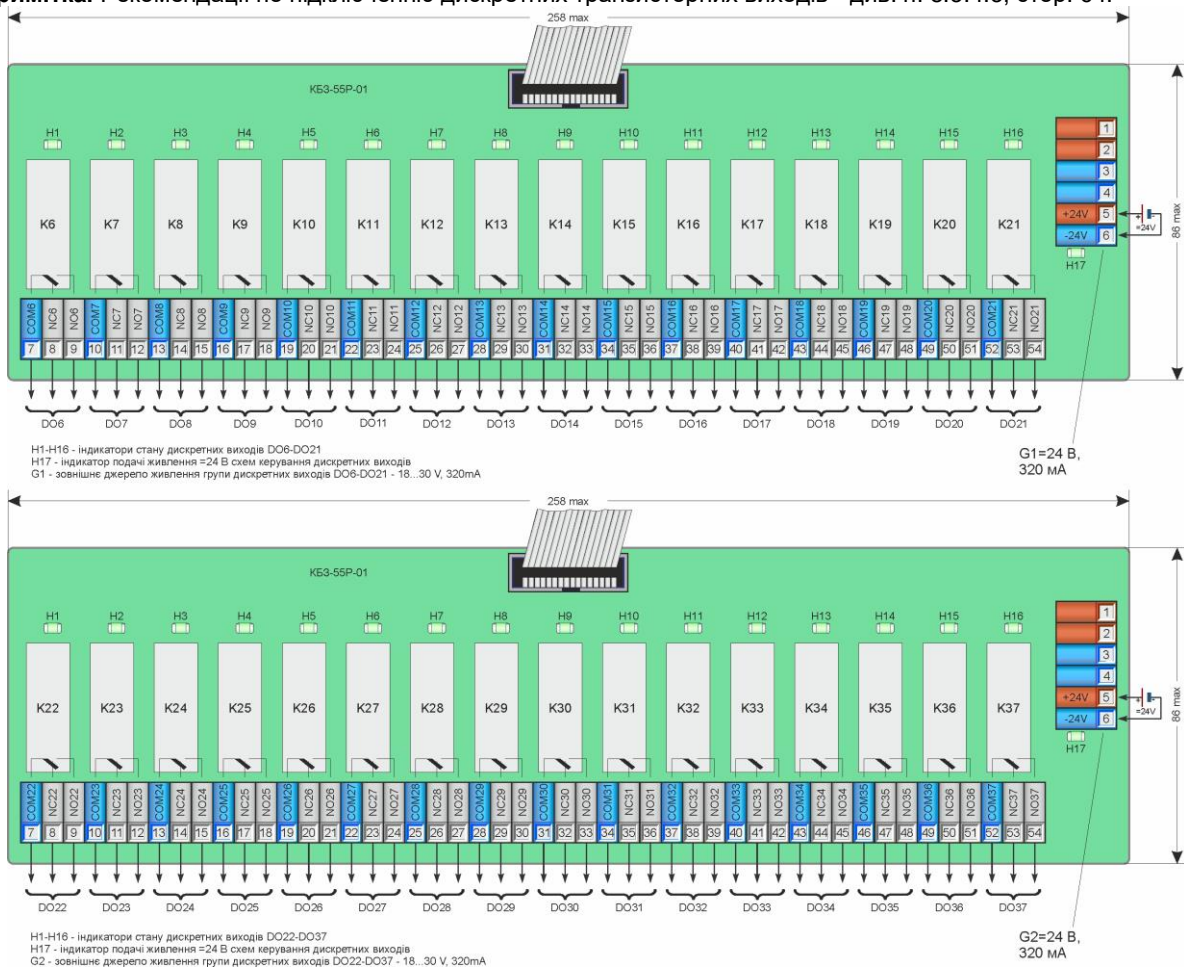
Рисунок 8.4.23 - Підключення сигналів модуля розширення MP-52-34 за допомогою клемно-блокового з'єднувача КБ3-55P-01 (два КБ3-54P-01)
