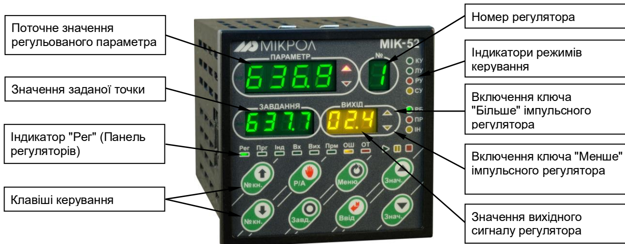
Рисунок 4.3 - Передня панель в режимі оперативного керування контурами регулювання
