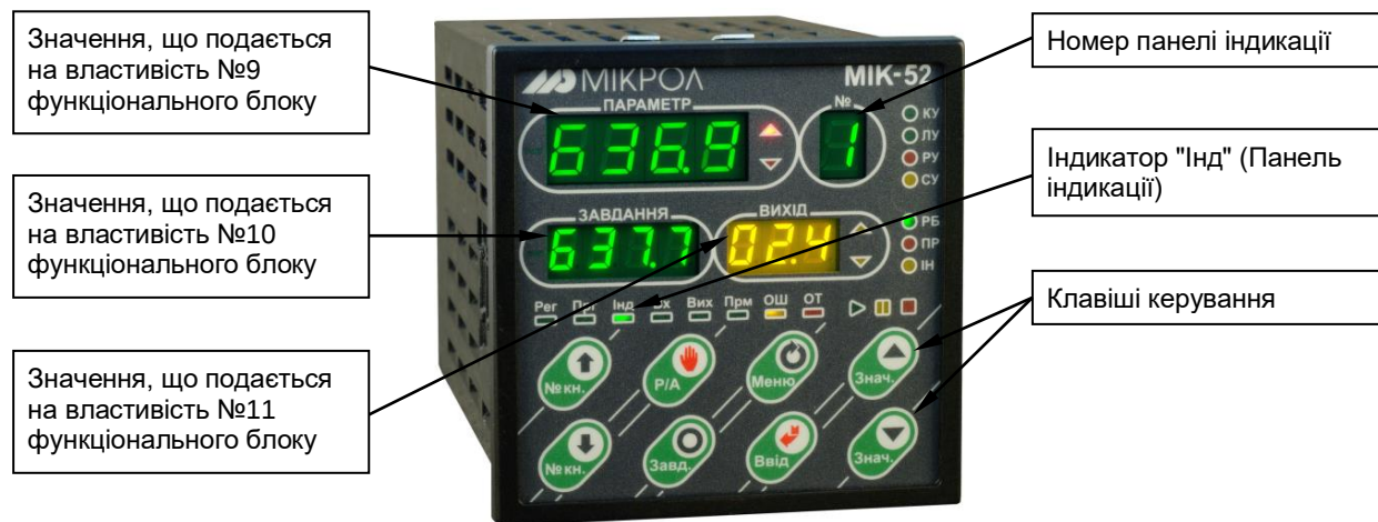
Рисунок 4.6 - Передня панель в режимі оперативного керування програмним задавачем
