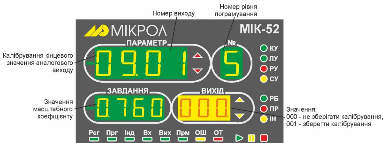
Рисунок 9.4.2.2 - Зовнішній вигляд індикаторів при калібруванні кінцевого значення аналогового виходу
