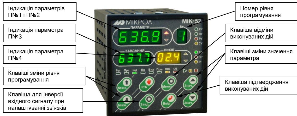
Рисунок 5.1 - Передня панель контролера MIK-52 в режимі програмування
