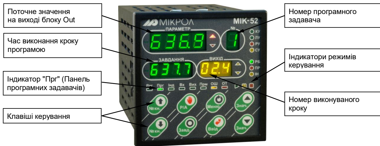
Рисунок 4.5 - Передня панель в режимі оперативного керування програмним задавачем
