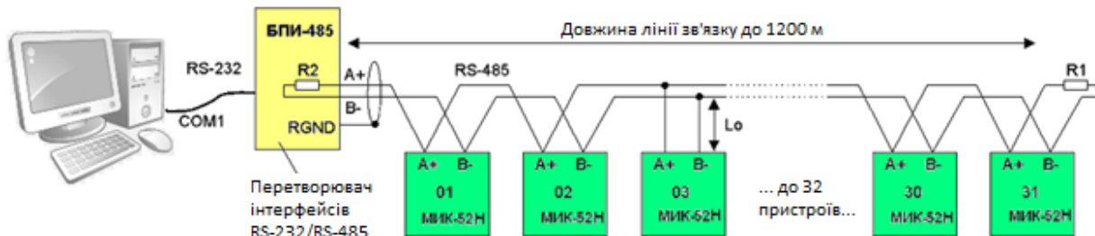
Рисунок 3.1 - Структурна схема підключення інтерфейсних кіл
