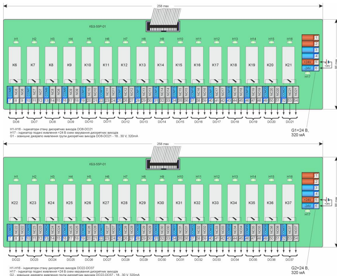
Рисунок 8.4.23 - Підключення сигналів модуля розширення MP-52-34 за допомогою клемно-блокового з'єднувача KB3-55P-01 (два KB3-54P-01)
