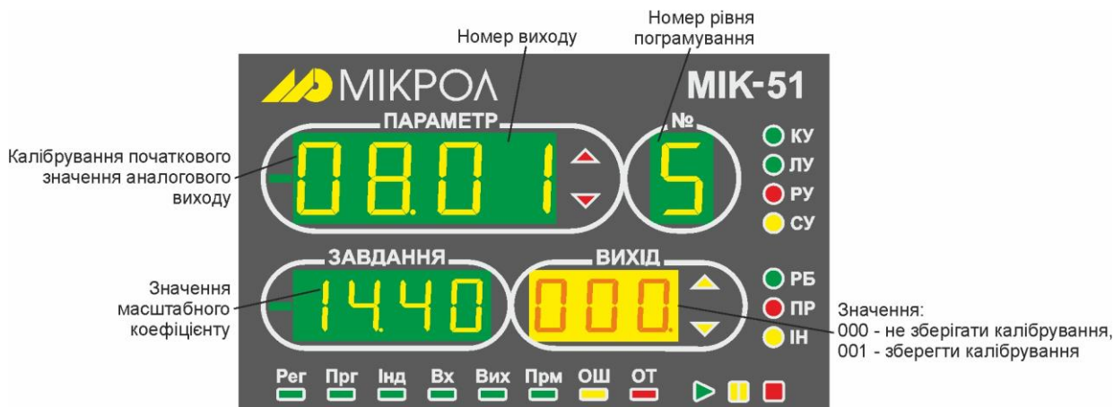
Рисунок 9.4.2.1 - Зовнішній вигляд індикаторів при калібруванні нуля аналогового виходу
