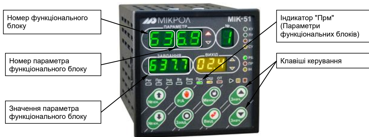
Рисунок 4.9 - Лицьова панель в режимі індикації параметрів функціональних блоків
