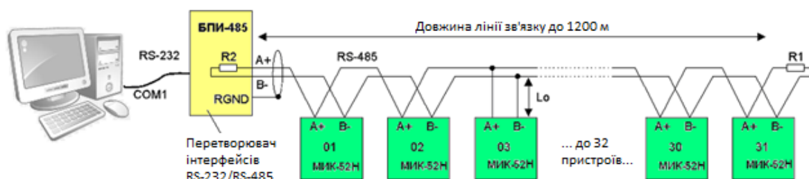
Рисунок 3.1 - Структурна схема підключення інтерфейсних кіл
