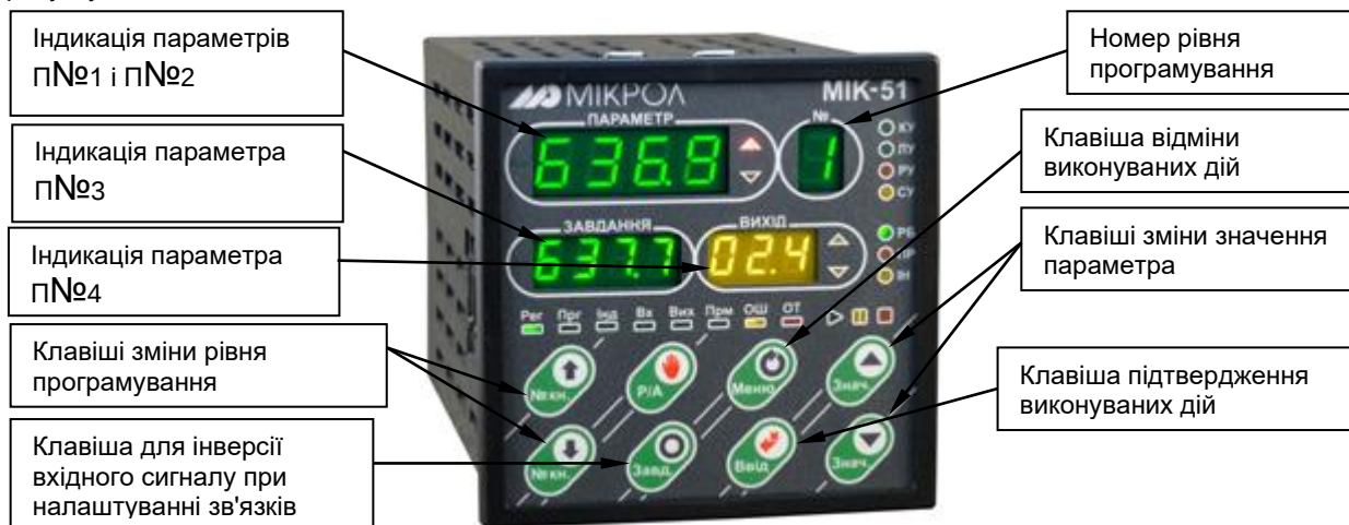
Рисунок 5.1 - Лицьова панель контролера МІК-51 в режимі програмування
