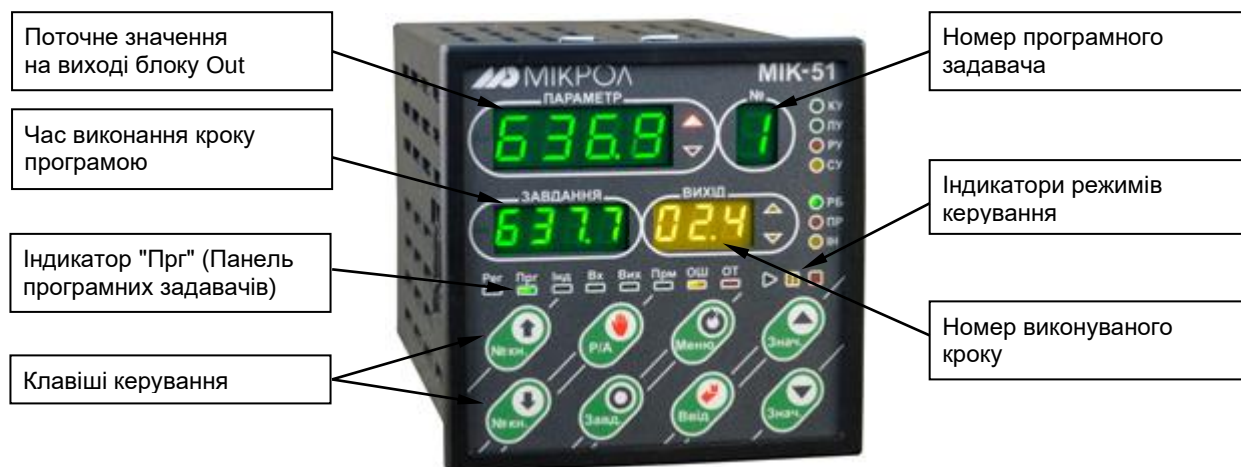
Рисунок 4.5 - Лицьова панель в режимі оперативного керування програмним задавачем
