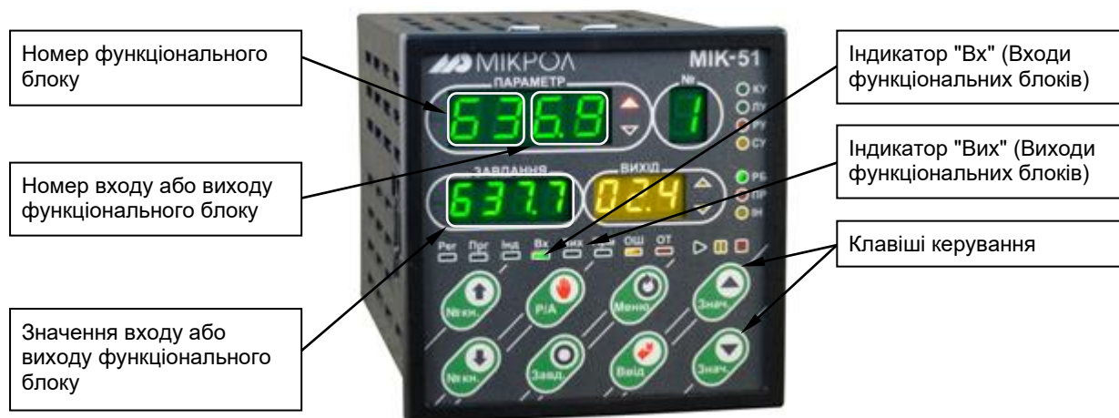
Рисунок 4.7 - Лицьова панель в режимі індикації вхідних або вихідних параметрів функціональних блоків
