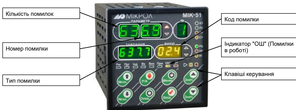
Рисунок 4.9 - Лицьова панель в режимі індикації помилок
