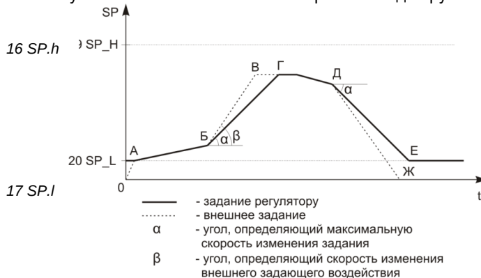
Таблиця 8.90.3 - Функції режимів балансування аналогового ПІД-регулятора блоку PID_R(90)
