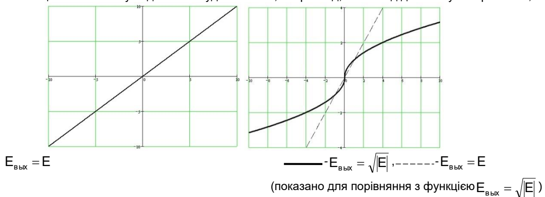
Рисунок 8.62.3 – Графік обробки сигналу неузгодженості
