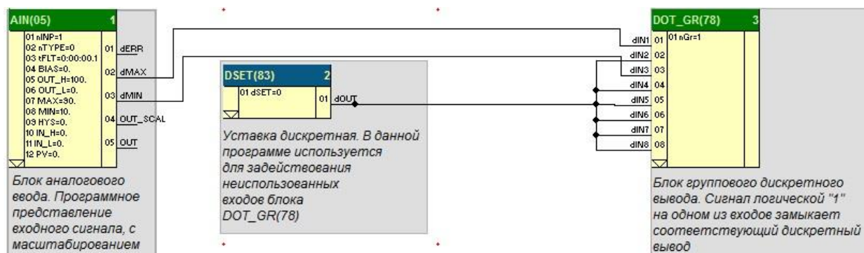
Рисунок 3.78.2 – Приклад роботи блоку DOT_GR(78)
