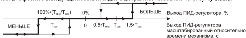
Рисунок 8.91.5 – Діаграма спрацьовування та відключення дискретних виходів при заданій мінімальній тривалості імпульсу
