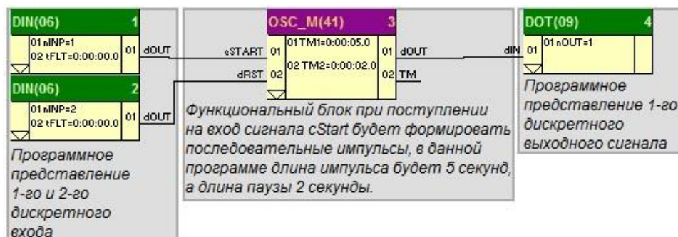
Рисунок 6.41.2 - Приклад роботи блоку OSC_M(41)
