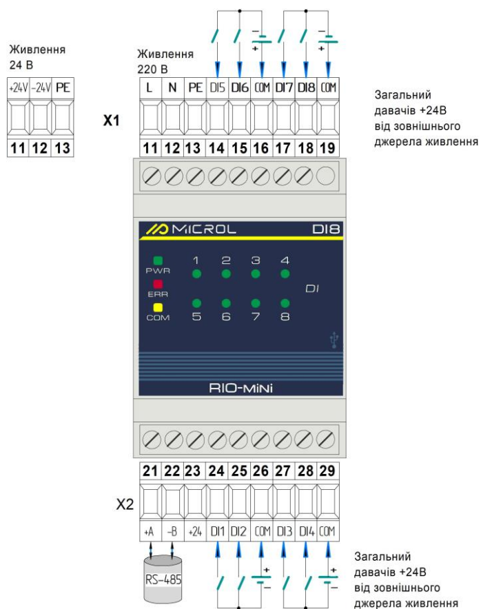
Малюнок Б.3 - Підключення зовнішніх ланцюгів модуля RIO-MINI DI8 із зовнішнім джерелом живлення та спільним «+»
