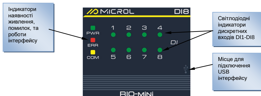
Малюнок 3.2 – Зовнішній вигляд передньої панелі модуля RIO-mini DI8 з LED індикацією
