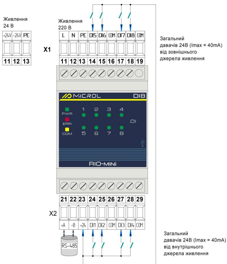
Малюнок Б.1 - Підключення зовнішніх ланцюгів модуля RIO-MINI DI8 з внутрішнім джерелом живлення
