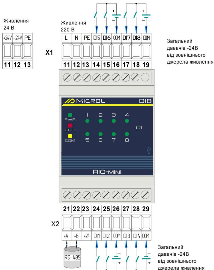
Малюнок Б.2 - Підключення зовнішніх ланцюгів модуля RIO-MINI DI8 із зовнішнім джерелом живлення та спільним «-»
