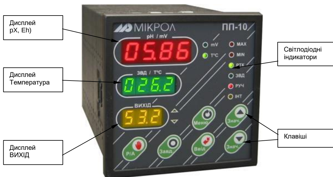
Рисунок 5.1. Зовнішній вигляд передньої панелі перетворювач-регулятора ПП-10
