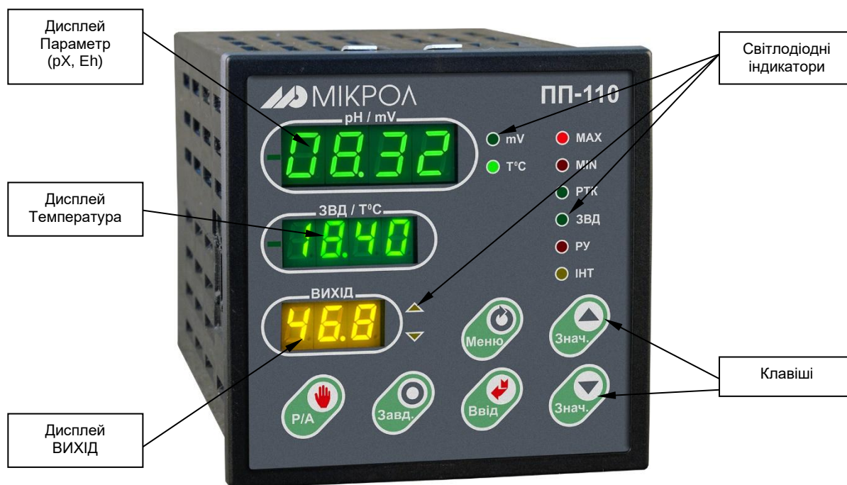
Рисунок 3.1-Зовнішній вигляд передньої панелі перетворювача-регулятора ПП-110
