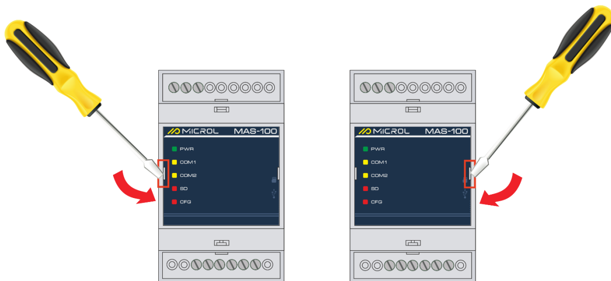
Рисунок 4.3 - Схема зняття передньої кришки
