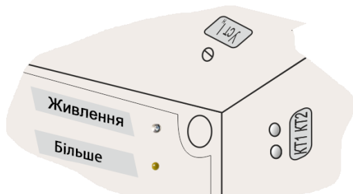
Рисунок 4.3 – Схема встановлення струмового захисту у пускачі
