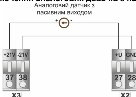
Рисунок Б.2 - Підключення до індикатора ІТМ-110 аналогового датчика з пасивним виходом
