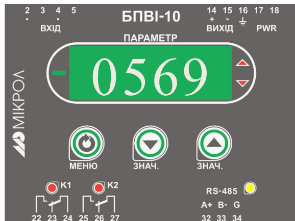
Рисунок А.1 – Зовнішній вигляд передньої панелі перетворювача БПВІ-10
