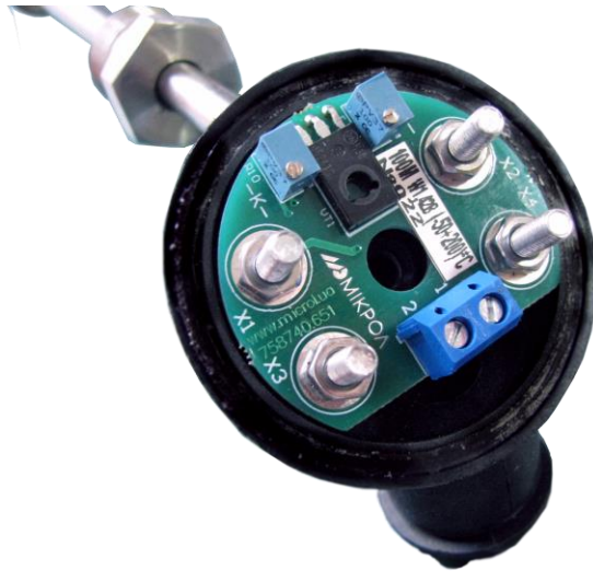
Рисунок 2 - Схема установки перетворювача БПО-530 в головку датчика
