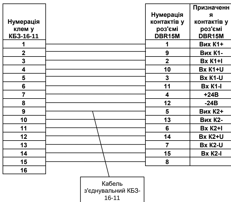
Рисунок 2.3 - Схема розпаювання кабелю клемно-блокового з'єднувача KB3-16-11 та зовнішні сигнали БПО-42
