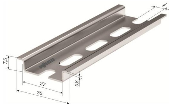
Рисунок 4.2 - Зовнішній вигляд і розміри DIN-рейки Wago
