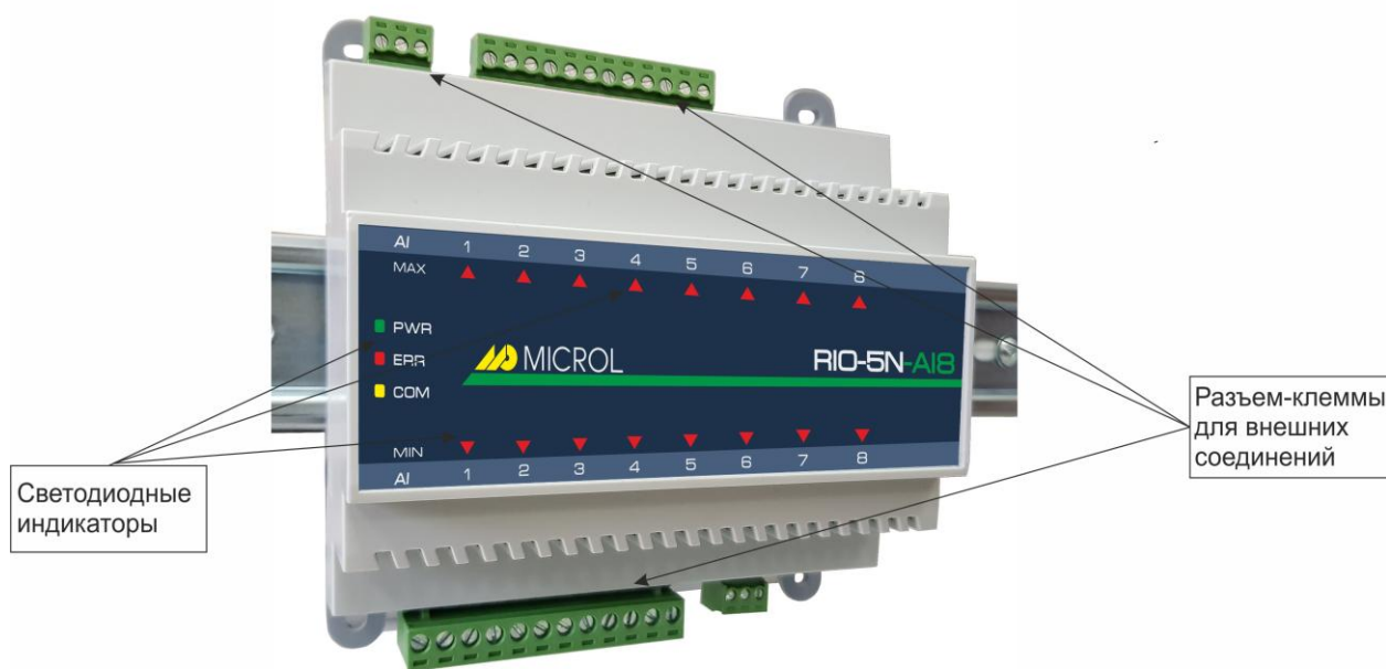
Рисунок. 3.1 - Зовнішній вигляд модуля аналогового вводу RIO-5N-AI8
