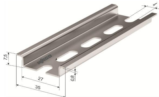
Рисунок 4.2 – Зовнішній вигляд та розміри DIN-рейки Wago
