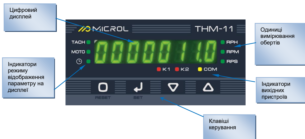
Рисунок 3.1 – Зовнішній вигляд передньої панелі тахометра ТНМ-11
