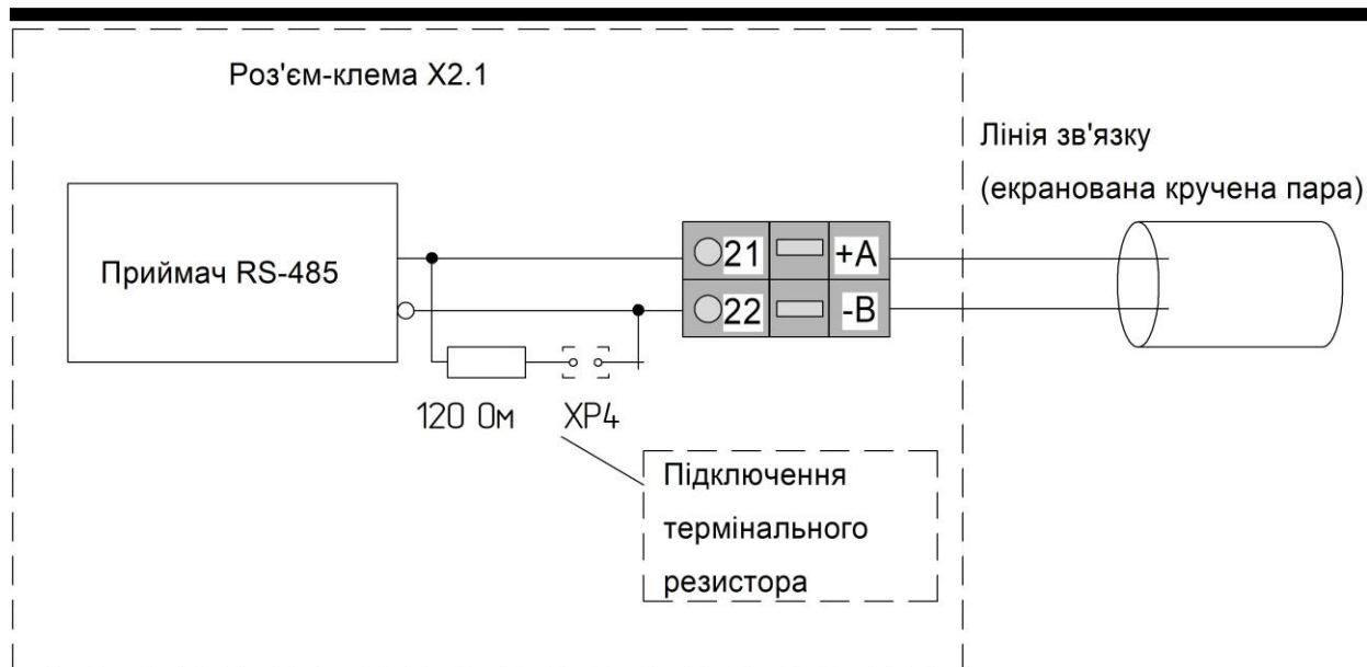
Рисунок Б.2 - Рекомендована схема підключення інтерфейсу RS-485
