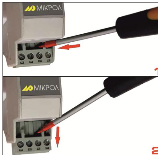
Рисунок 3.3 - Схема вилучення роз'єм-клеми за допомогою плоскої викрутки
