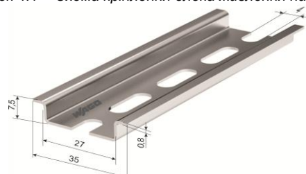
Рисунок 4.2 – Зовнішній вигляд та розміри DIN-рейки Wago
