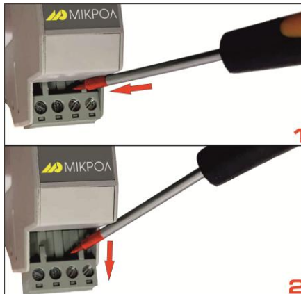
Рисунок 3.3 – Схема вилучення роз'єм-кlemi за допомогою плоскої викрутки
