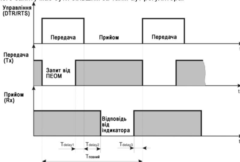
Рисунок В.1 - Тимчасові діаграми управління передачею та прийомом блоку інтерфейсів БПІ-485 (БПІ-52)
