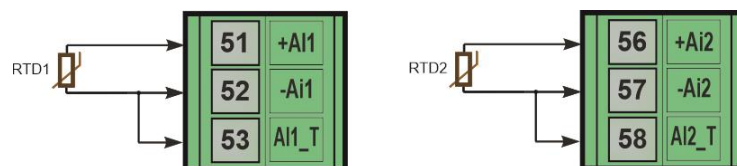
Рисунок Б.2.2 – Двох провідна схема підключення термоопорів
