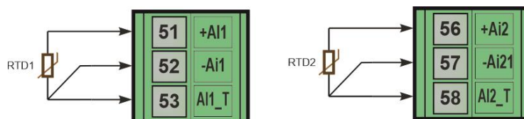
Рисунок Б.2.1 – Трьох провідна схема підключення термоопорів
