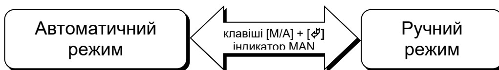
Рисунок 4.6.1 – Режими роботи регулятора МІК-122-К7
