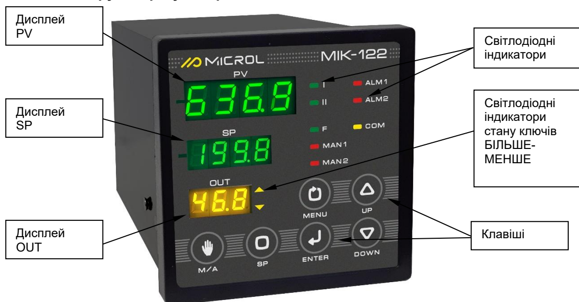
Рисунок 3.1 - Зовнішній вигляд передньої панелі регулятора MIK-122-K7
