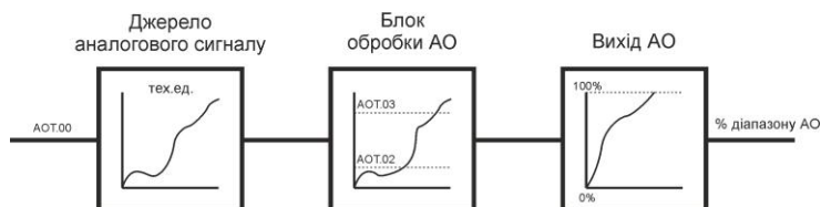
Рисунок 3.19 - Робота блоку аналогового виходу в режимі ретрансмісії
