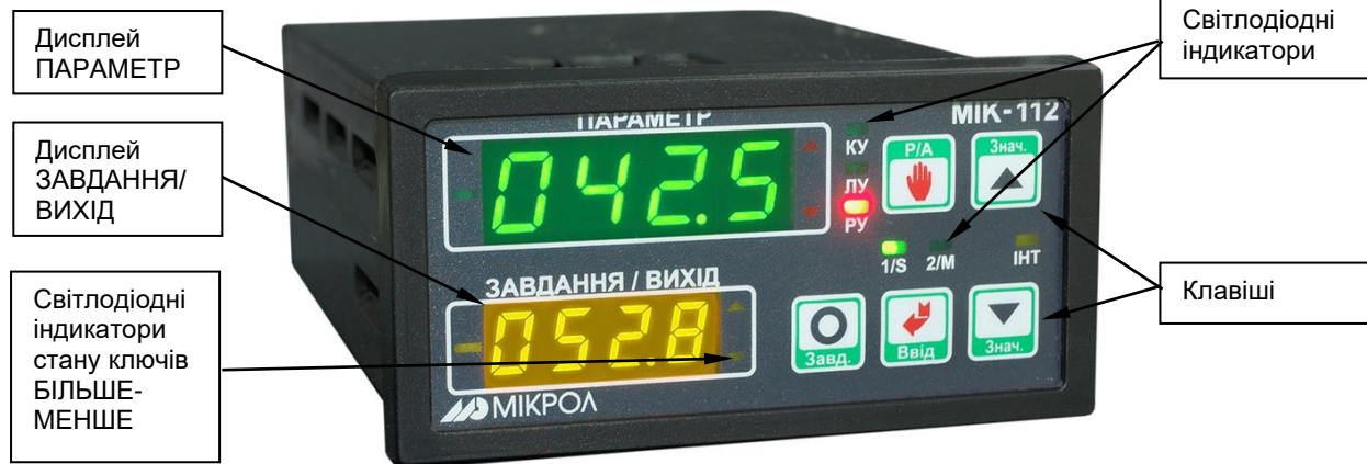
Рисунок 3.1 - Зовнішній вигляд передньої панелі регулятора MIK-112
