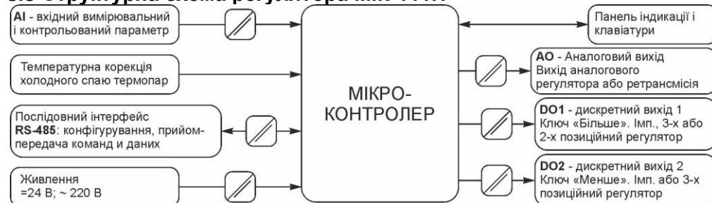
Рисунок 3.2 - Структурна схема регулятора МІК-111Н
