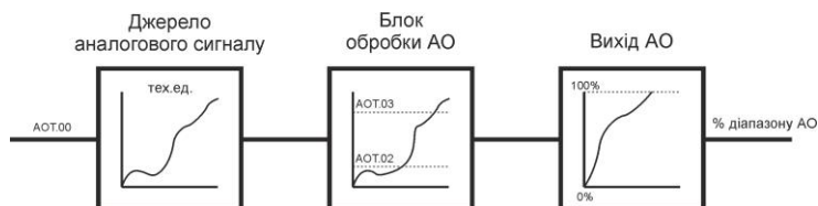
Рисунок 3.12 - Робота блоку аналогового виведення в режимі ретрансмісії
