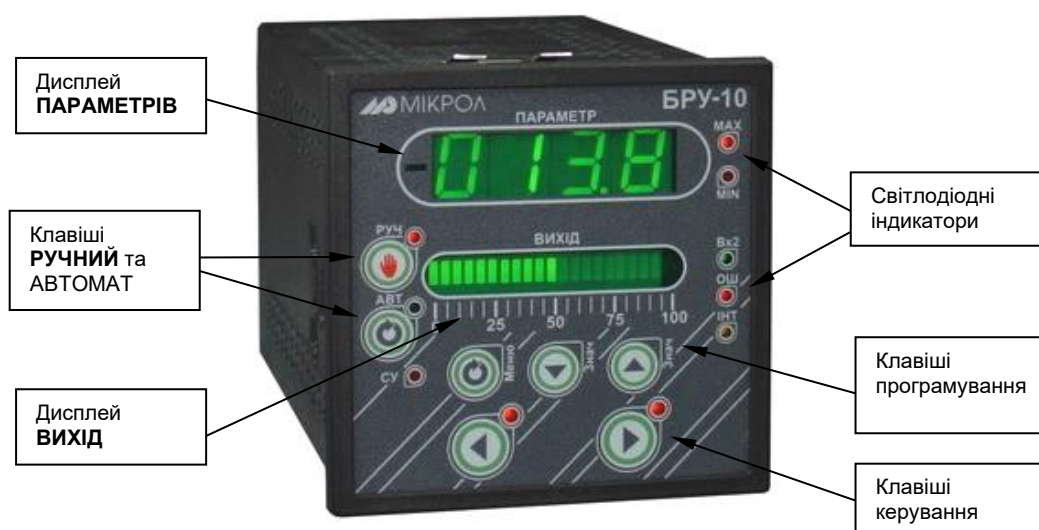
Рисунок. 5.1 - Зовнішній вигляд передньої панелі блоку ручного керування БРУ-10
