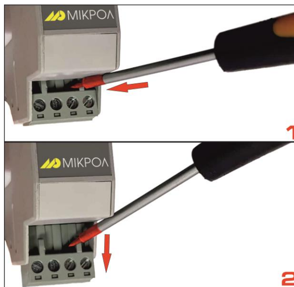
Рисунок 3.3 – Схема виймання роз'єму-клету з допомогою плоскої викрутки
