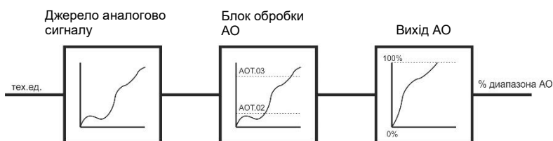
Рисунок 3.6 – Робота блоку аналогового виведення у режимі перетворення
