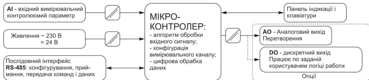
Рисунок 3.2 – Структурна схема амперметра ІПМ-3Н
