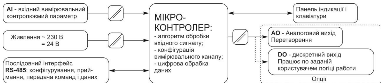
Рисунок 3.2 – Структурна схема вольтметра ІПМ-2Н
