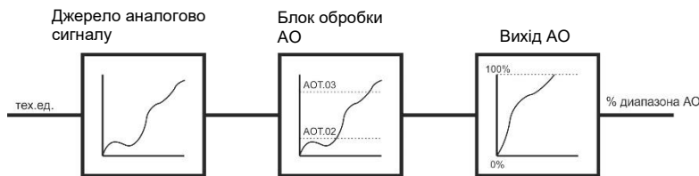
Рисунок 3.6 – Робота блоку аналогового виведення у режимі ретрансмісії
