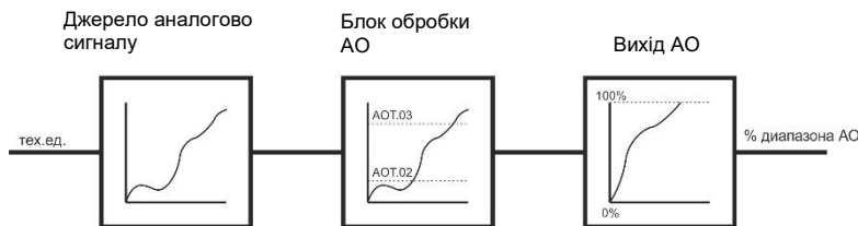
Рисунок 3.6 – Робота блоку аналогового виходу у режимі перетворення
