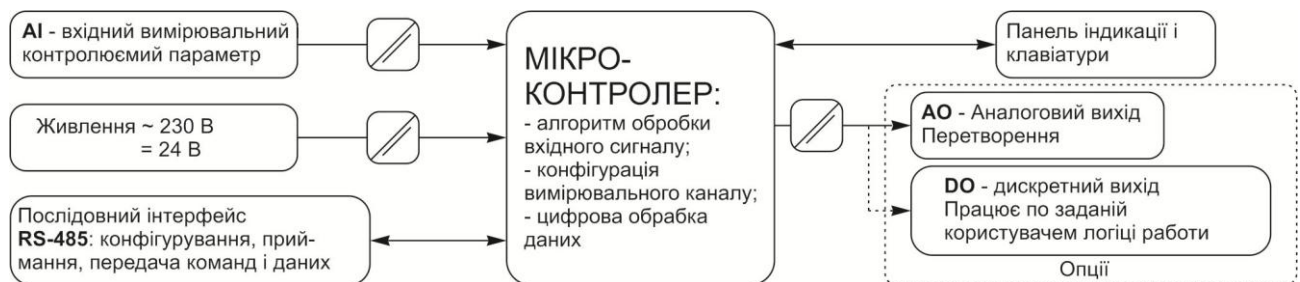
Рисунок 3.2 – Структурна схема вольтметра ІПМ-1Н
