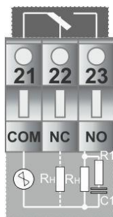
Рисунок Б.2 – Схема підключення індуктивного навантаження до механічного реле
