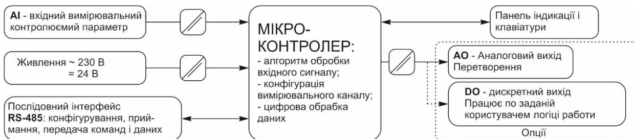
Рисунок 3.2 – Структурна схема амперметра ІПМ-3
