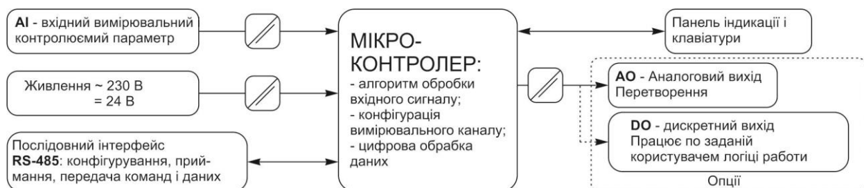
Рисунок 3.2 – Структурна схема вольтметра ІПМ-2
