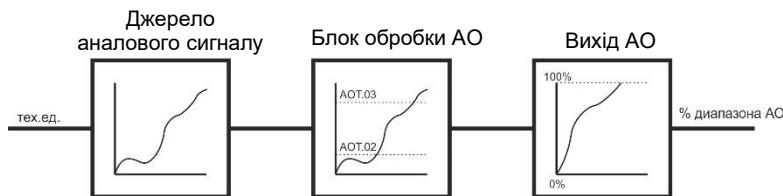
Рисунок 3.6 – Робота блоку аналогового виведення у режимі ретрансмісії
