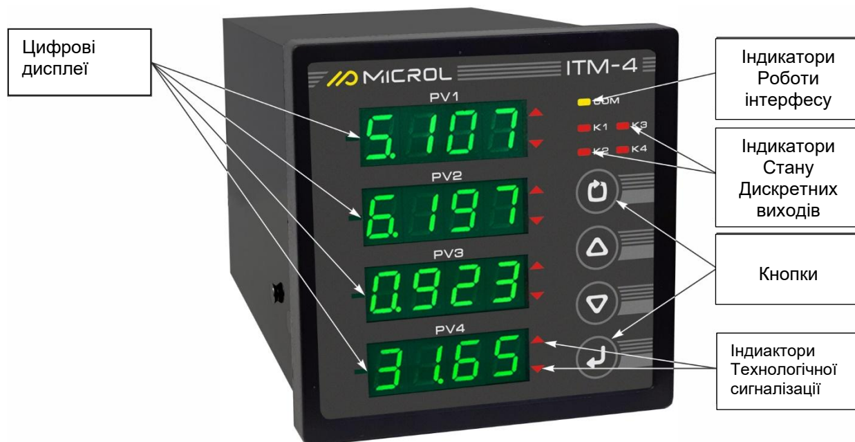
Рисунок 3.1 – Зовнішній вигляд передньої панелі індикатора ITM-4K7
