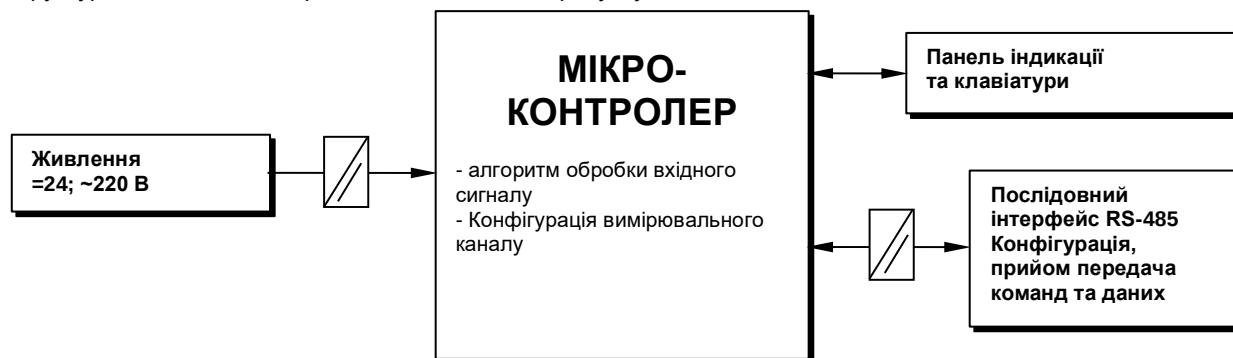
Рисунок 2.2 – Структурна схема індикатора ІТМ-110С
