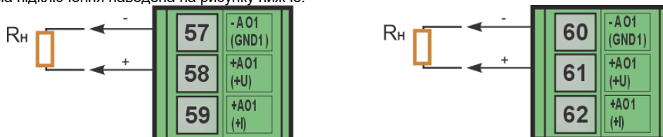
Рисунок Б.3.6 – Схема підключення виходу постійної напруги
